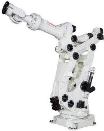
当社最大となる可搬質量 1t の超重可搬・高剛性ロボット「MG10HL」を 2015 年 12 月 2 日より新発売します。昨今、自動車や船舶、鉄道車両、航空機などの大型製品のほか、1t に及ぶ重量の鋳造品・鍛造品ならびに資材・建材など、超重量物の搬送ニーズが高まっているため、当社はこれまでの最大機種である M シリーズ(最大可搬質量 700kg)に加えて、汎用用途に適用できる超重可搬ロボット「MG10HL」を新たに開発しました。
